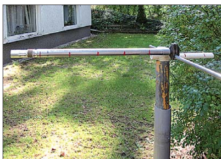
Bild 2: Prüfung der Laminierung auf Verdrehesicherheit; das Stahlrohr verformte sich durch die Einspannung (!), die Laminierung hielt stand.
