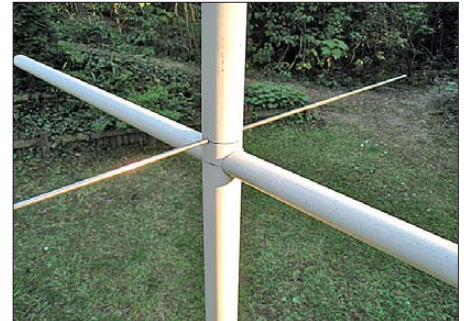
Bild 3: Vorbereitung der Laminierung des 28-mm-Kreuzrohrs; auf die Orthogonalität der drei Rohre untereinander ist sorgfältig zu achten.
