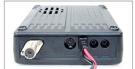
Bild 3: v.l.n.r. PL-Antennenbuchse, Datenbuchse für PC bzw. Modem, DC-Kabel, NF-Eingang und Lautsprecherbuchse
