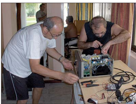
Silvano, I2YSB (I.), und Alfeo, I1HJT, reparieren reparieren eine Acom-1000-Endstufe.
