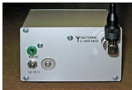
Bild 6: Die BNC-Buchse zum Anschluss der Stabantenne befindet sich an der Gehäuserückwand. Fotos: DK6UU
