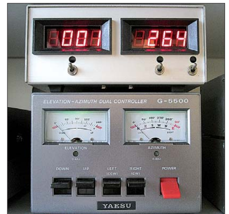
Bild 19: Bei 10-GHz-Antennen ist die Richtungsanzeige am unteren Originalgerät faktisch unbrauchbar. Die winkelgradgenaue Anzeige erfolgt deshalb im oberen Gerät digital. Die normale Antennendrehgeschwindigkeit kann beibehalten oder mit Impulssteuerung verringert werden.
