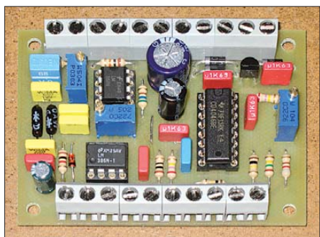
Bild 3: Die Platine bildet das Herzstück des Gerätes, alle peripheren Bauteile werden über Schraubklemmen angeschlossen.
