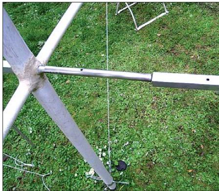
Bild 1: Das Boommaterial wird auf ein Edelstahlrohr geschoben und mit jeweils einer M5-Schraube gesichert. Das einlaminierete Trägerrohr erspart die Mastschelle.
