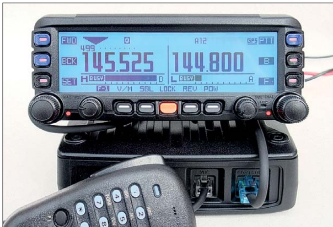
Bild 1: Bedienteil und Grundgerät sind getrennte Einheiten. Das exzellente Display liefert alle wichtigen Informationen auf einen Blick. Das Mikrofon lässt sich wahlweise am Grundgerät (unten im Bild) oder am Bedienteil anstecken.
