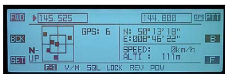
Bild 5: Wenn ein GPS-Modul angeschlossen ist, erscheint eine Statusanzeige.
