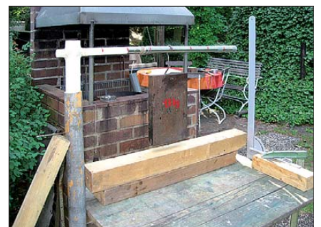
Bild 4: Prüfung des zulässigen Biegemoments; zum Bruch kam es nicht.
