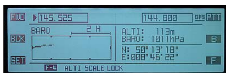
Bild 7: Ein eingebauter Luftdruckmesser ermittelt Luftdruck und Höhe.
