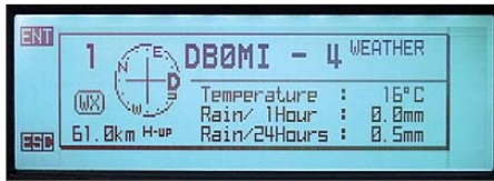
Bild 11: APRS-Meldungen werden als Pop-up-Fenster über die normale Anzeige für eine einstellbare Zeit eingeblendet.
