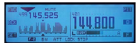
Bild 4: Kurzes Drücken auf den Abstimmknopf blendet eine Spektrumsanzeige ein.
