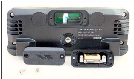
Bild 10: Mit dem optionalen GPS-Modul FGPS-1 steht die Navigationsfunktion zur Verfügung.
